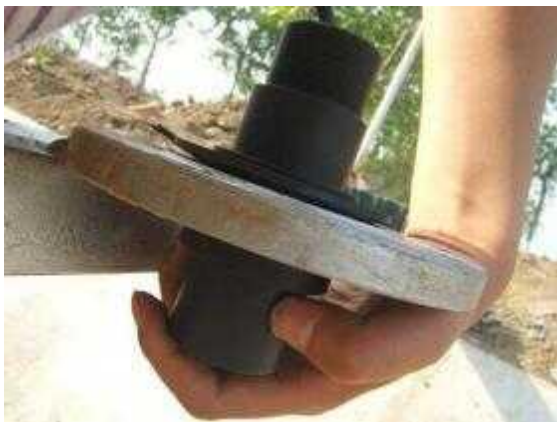
图 3-7 拧上螺母固定好换能器
