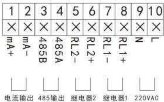
图 7-4 220V 防爆型四线制接线端子示意图
