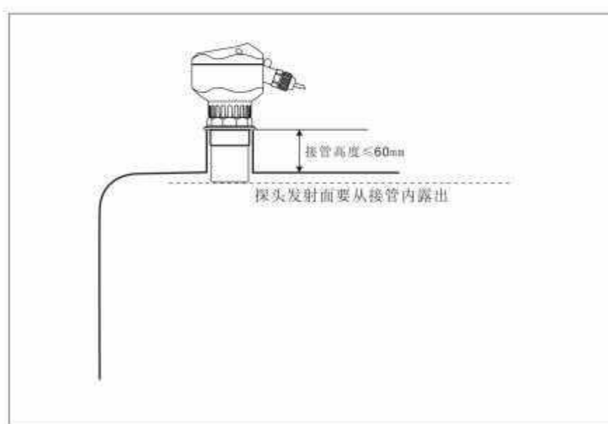
图 6-13 探头发射面从接管内露出示意图
